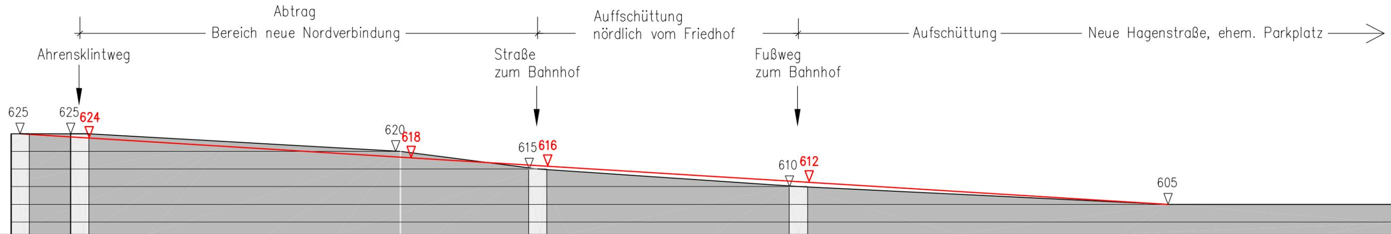
GELÄNDEPROFIL MIT EINTRAG DER NEUEN PROFILIERUNG FÜR DIE NORDVERBINDUNG M 1:1000
